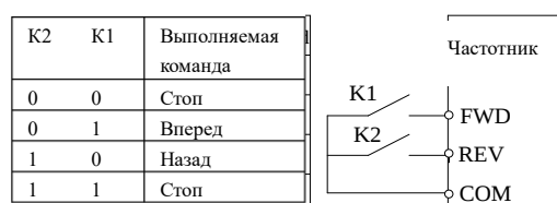
Рис.6-13 Двухпроводной режим управления 1
